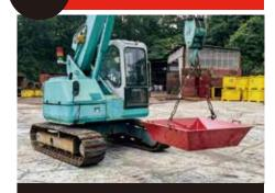
オール金属製のため、ブラスチック製のブラ舟や トロ函より高い耐久性。ハードな現場作業で長期間 ご利用いただけます。玉掛作業にも対応しています。
